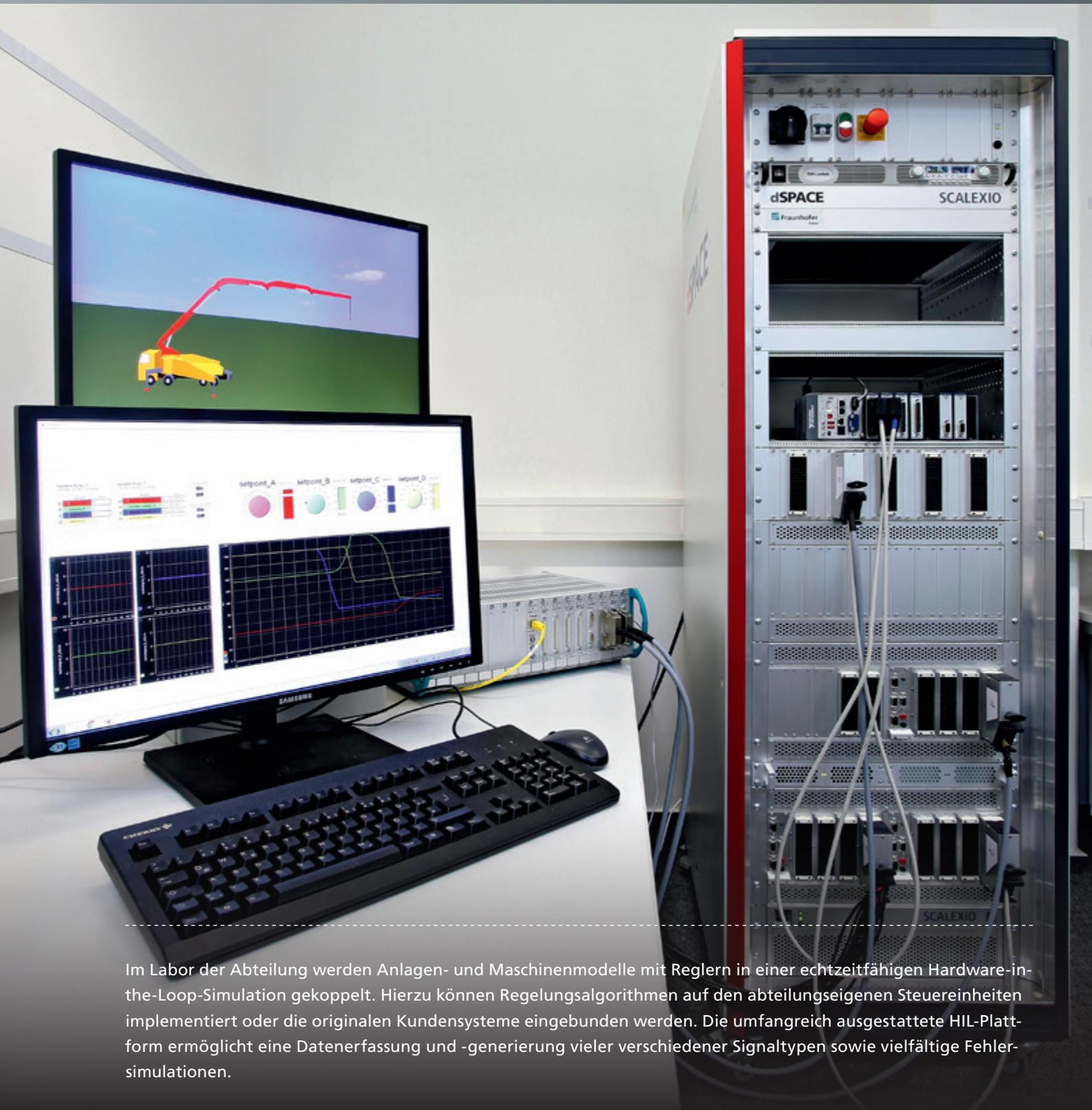
Im Labor der Abteilung werden Anlagen- und Maschinenmodelle mit Reglern in einer echtzeitfähigen Hardware-in-the-Loop-Simulation gekoppelt. Hierzu können Regelungsalgorithmen auf den abteilungseigenen Steuereinheiten implementiert oder die originalen Kundensysteme eingebunden werden. Die umfangreich ausgestattete HIL-Plattform ermöglicht eine Datenerfassung und -generierung vieler verschiedener Signaltypen sowie vielfältige Fehler-simulationen.
